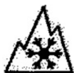
Рисунок 5.1. Маркировка, наносимая на зимнюю шину
